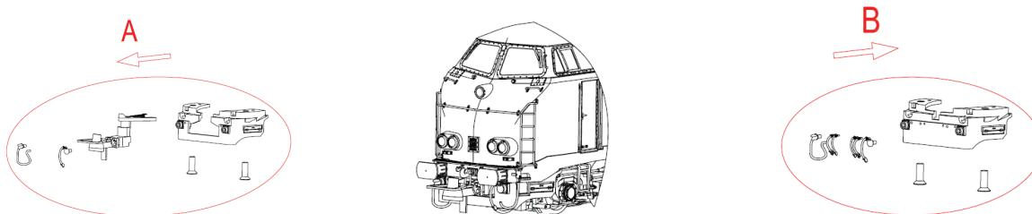
Om de lok te openen, verwijder voorzichtig de 4 kleine vijsjes aan de onderkant van de kap (fig A) en vervolgens opent u de loc voorzichtig (fig B).
