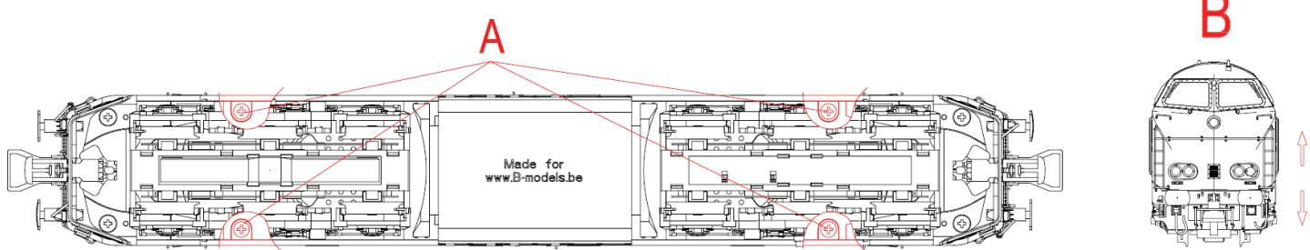
*Afin d'ouvrir la locomotive, dévissez les 4 petites vis en bas de la caisse (fig.A) avec précaution et ouvrez la locomotive avec prudence (fig.B).*
